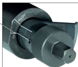
Markierungslinie im Neuzustand (Go) Marking line in new condition (Go)
